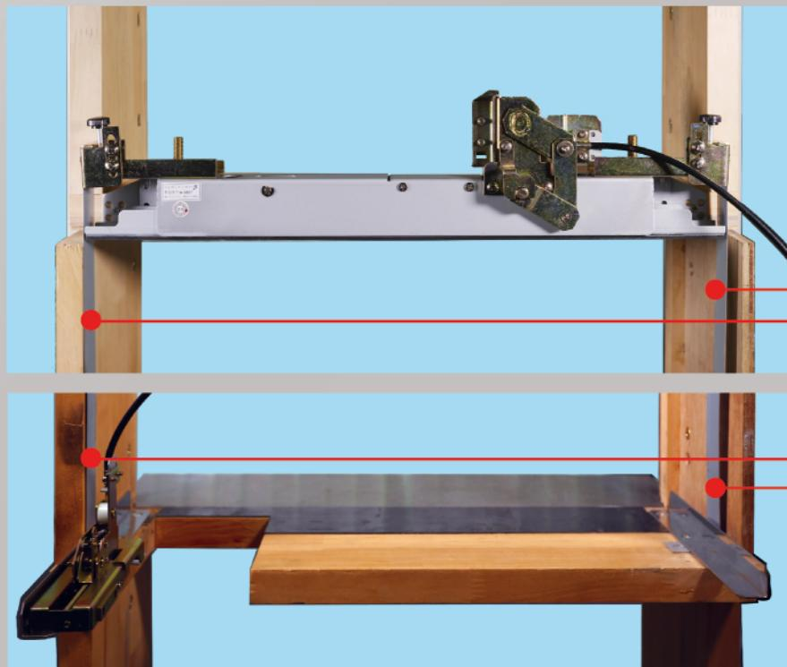
金属製フレームは、上部ロック機構に結合。そのままストッパーと台下部に連結されます。このため、台固定時の負荷は、島下部で受け止める構造となっており、島を傷めることはありません。さらに従来より強力に台を固定します。
