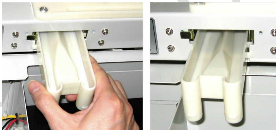
押し込みながら下に降ろす
