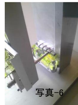
※4の作業で、任意の傾斜における気泡管のズレ及び気泡同士の平行が取れていない場合付属のφ 1.5mmの調整六角レンチ(写真-8)を調整孔へ挿入し(写真-9)、気泡管の調整を行う。六角レンチを時計回りに回すことによって、気泡が奥へ動きます。
