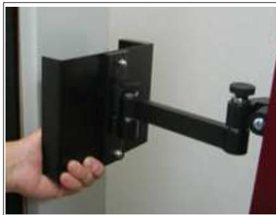
▲液晶パネルの固定金具をダイヤホー-IVの柱(正面の右側)に取り付けます。固定金具の裏面にマグネットシートが張って有りますので、一人での作業が可能です。
