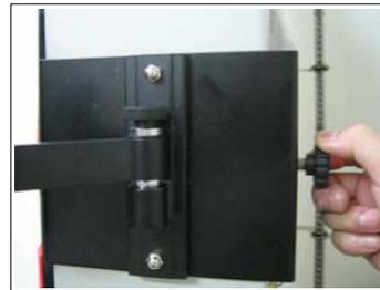
▲上部画像の左側にある固定ロックネジを必ず締めてください。脱落する恐れがあります。
